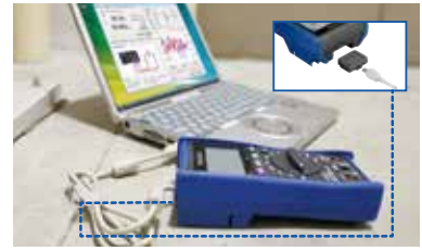
측정값을 현장에서 PC 에 저장 및 확인 통신 패키지 DT4900-01 (옵션)을 사용
