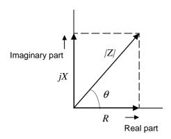
Z: Impedance( $\Omega$ )  $\theta$ : Phase angle (deg) R: Resistance( $\Omega$ ) X: Reactance( $\Omega$ )
