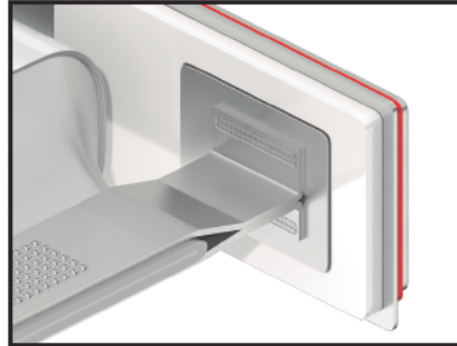
집전체와 출력단자의 용접
