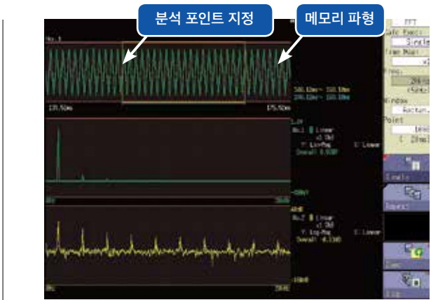
연산 원 (메모리 파형)과 FFT 연산결과를 동시에 표시
