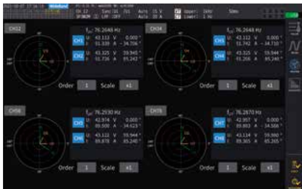
3P3W2M 결선에 의한 4 인버터·모터의 벡터 해석 예
