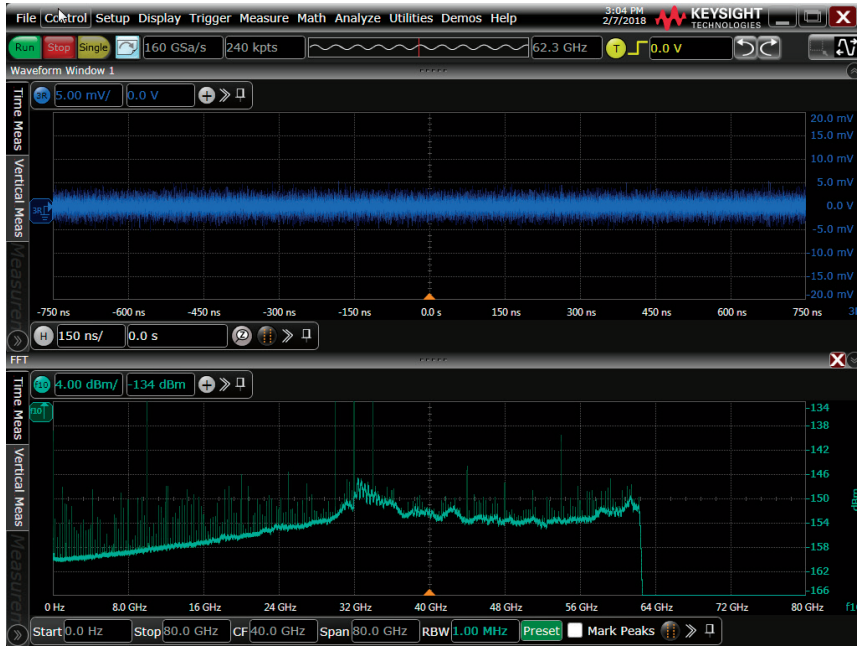
그림 6: 8비트 키사이트 오실로스코프의 노이즈 밀도 플롯, 주파수 인터리빙 사용
