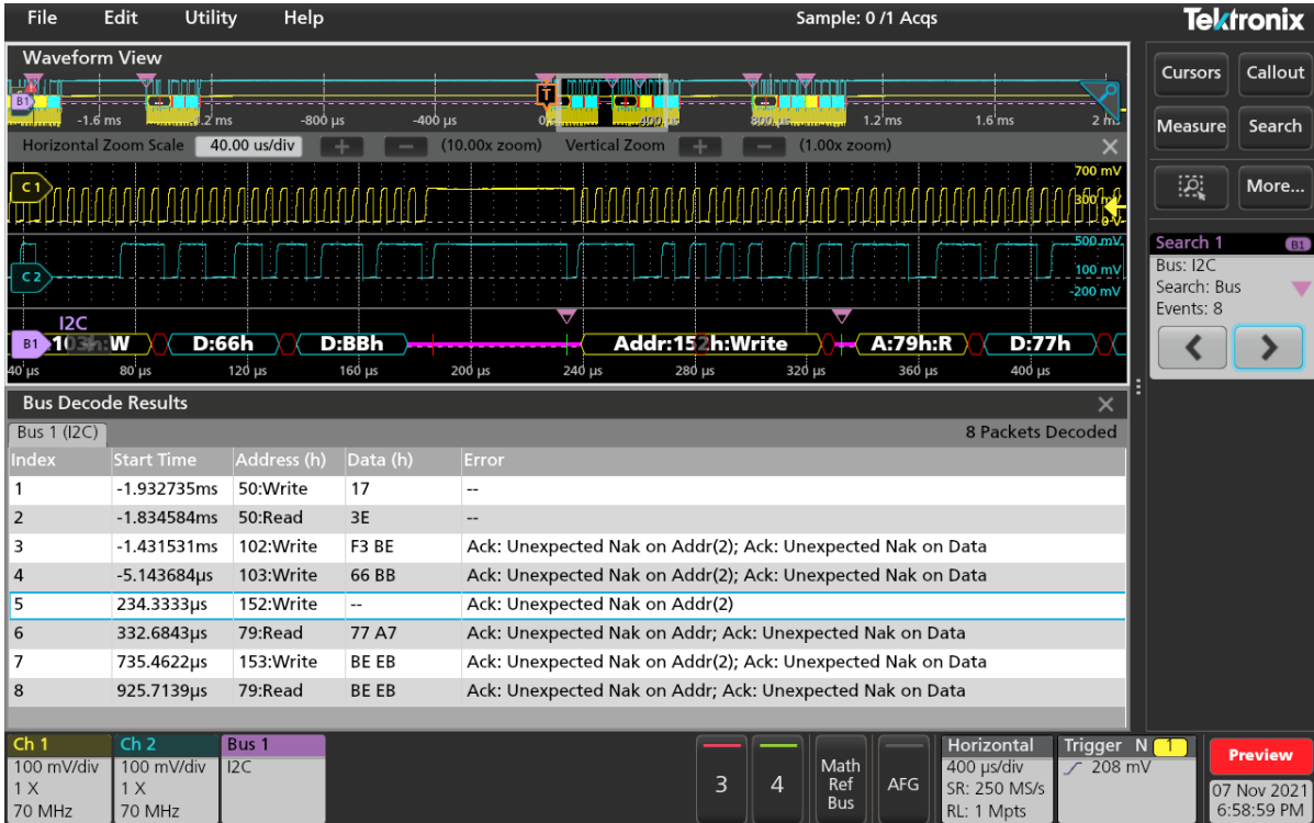
버스 파형은 시간 상관된 디코딩된 패킷을 제공하고 버스 디코딩 테이블은 전체 획득의 모든 패킷을 제공하며 검색은 탐색에 사용 가능
